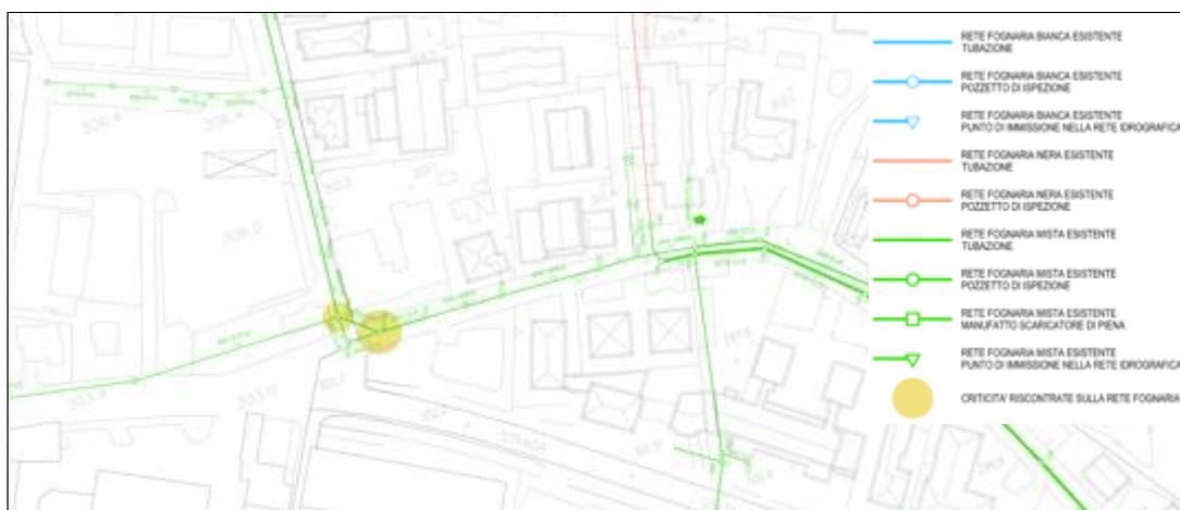
Stralcio della Tav. 1 allegata allo studio idraulico 2019 con individuazione della criticità idraulica riscontrata sulla rete fognaria all'incrocio tra via Rigla e via delle Roveri
